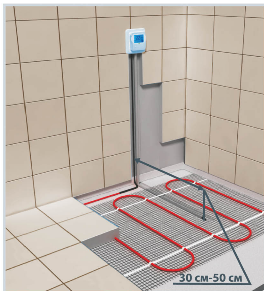
Схема укладки датчика температуры в гофрированной трубке
