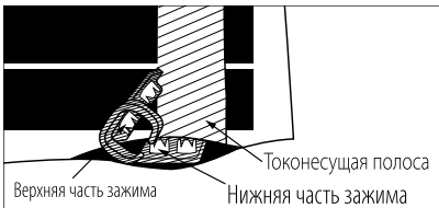
Нижняя часть зажима внутри медной токонесущей шины.
