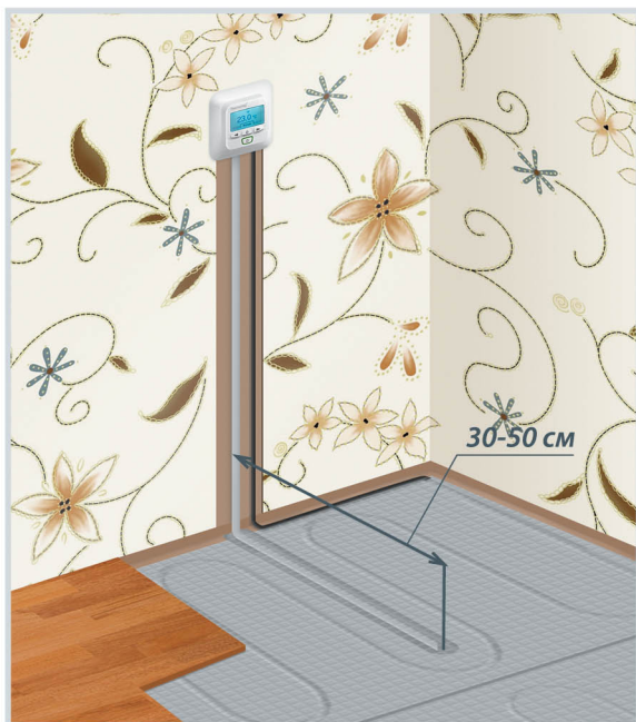
Схема укладки датчика температуры в гофрированной трубке
